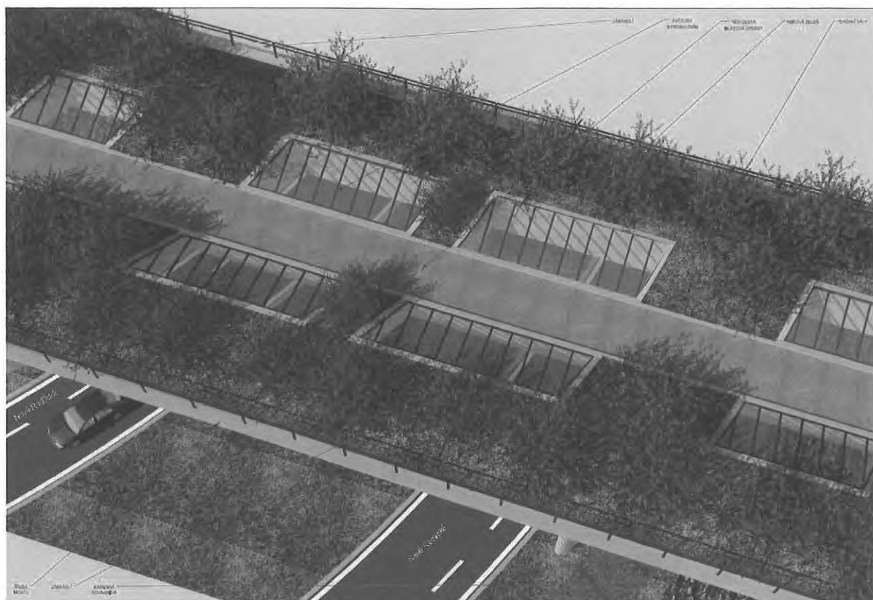
Skica a výsledná vizualizace biokoridoru přecházejícím po mostě přes Novou Radlickou ulici. Prostor pod mostem je otevřen a prosvětlen navrženými prosvětlovacími okny.
