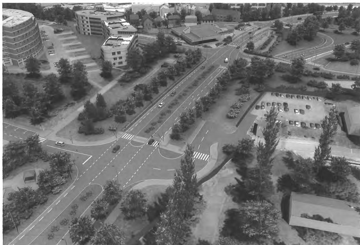
Radlická radiála v tunelovém provedení. Na stropě tunelu Nová Radlická ulice jako velkorysá městská třída s rezervou pro výhledovou tramvajovou trať podporující budoucí možnou zástavbu.
