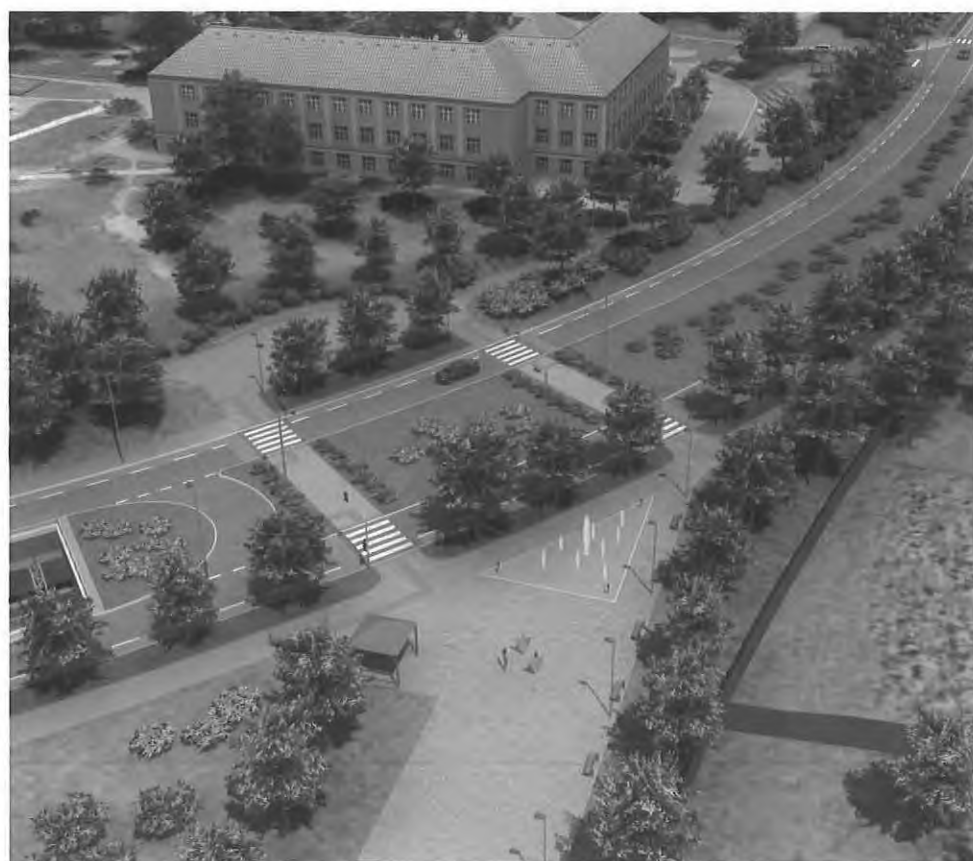
Skica a výsledná vizualizace biokoridoru přecházejícím po mostě přes Novou Radlickou ulici. Prostor pod mostem je otevřen a prosvětlen navrženými prosvětlovacími okny.
