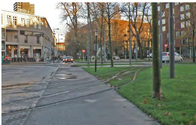
011 Průjezd tramvaje parkovým prostředím, kdy tramvajové těleso přirozeně přebírá charakter povrchu, přes který prochází [ Nizozemsko, Amsterdam ]
