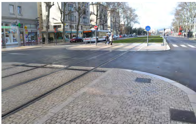
001 Vhodné provedení křížení nepojížděné tramvajové tratě a vozovky jasně vymezující dopravní prostor a prostor tramvajové tratě [ Francie, Le Havre ]
