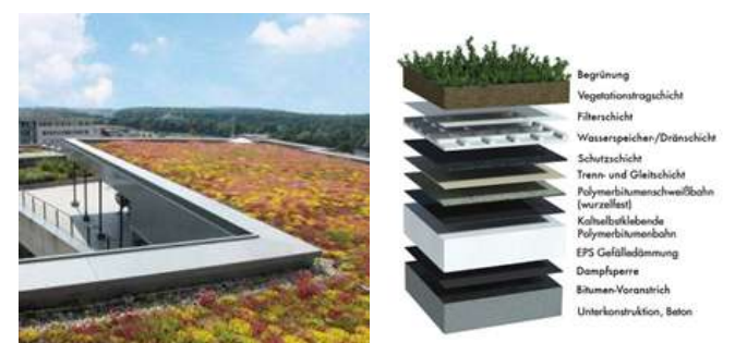
zelená střecha s funkcí zadržování dešťové vody
