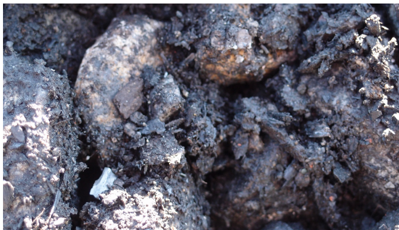
Obr. 37 Strukturální substrát tvoří štěrky velkých frakcí s příměsí jemných komponentů, homogenně propojené při jejich míchání.
