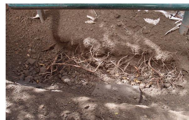
Obr. 7 Patrná změna intenzity prokořenění na hranici rozhraní ztuhnuté a neztuhnuté půdy
