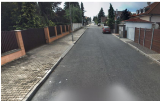
Obr. 40 Příklad nevhodně provedené obytné zóny s předimenzovanými dopravními plochami, bez možnosti výsadby
